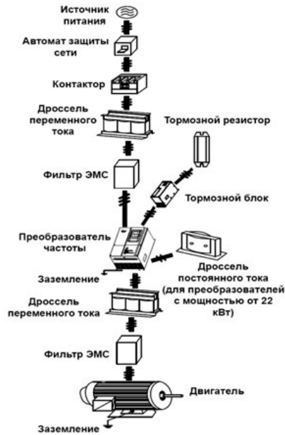
Рис. 1-2. Подключение преобразователя частоты
